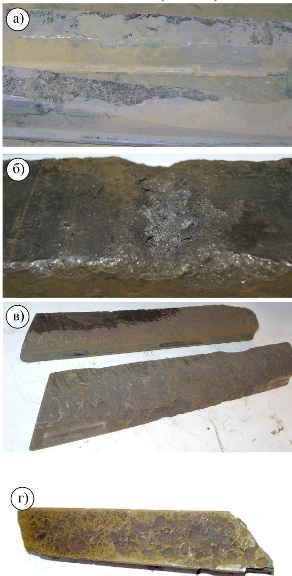
Рис. 1. Види зношування вставок полозів струмоприймачів: а) сколи вставок першого ряду; б, в) електро-дуговий вплив на вставки третього ряду; г) підпали підшви вставок
