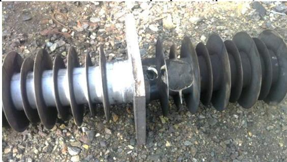
Рис. 2. Полимерный проходной изолятор, вышедший из строя по причине электрического старения изоляции
