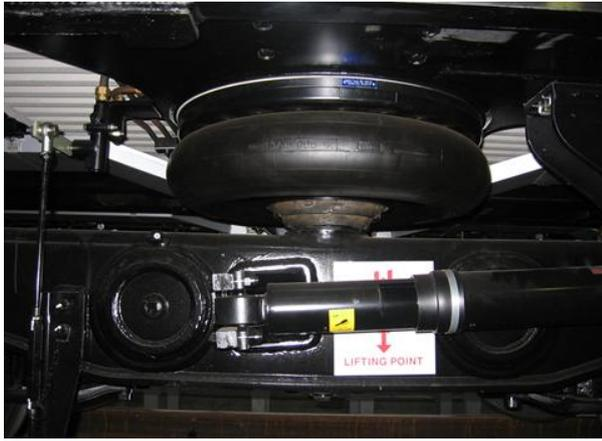
Рис. 2. Подвешивание кузова вагона на пневматических рессорах
