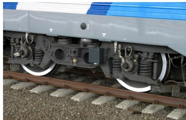
Рис. 1. Подвешивание кузова вагона на пружинных рессорах
