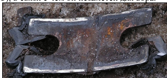
Рис. 2. Изображение внутренней поверхности соединителя (место контакта с рельсом)
