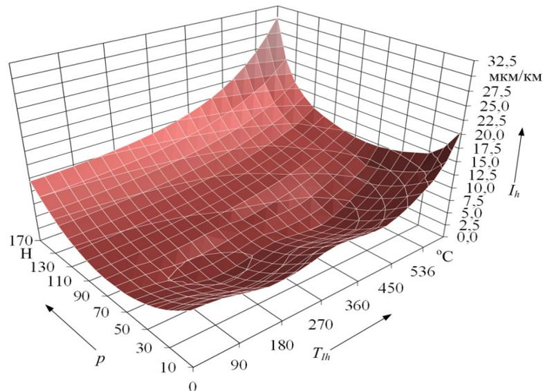
Рис. 1. Зависимость величины износа от контактного нажатия и температуры для КВ ВЖЗП
