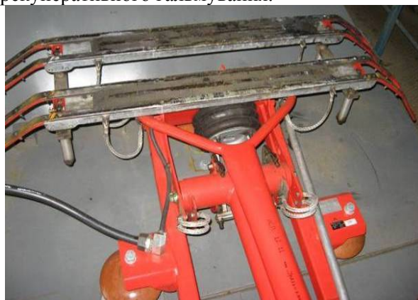
Рис. 6. Струмоприймач ТА-СТМ-140 після випробувань
