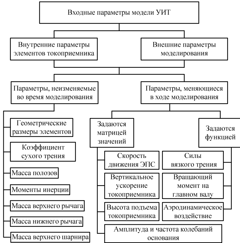
Рис. 6. Входные параметры модели универсального измерительного токоприемника
