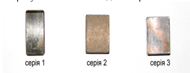
Рис. 1. Макроструктура напайок головних контролерів для електровозів: серія 1 – напайки виробництва ТОВ НПФ Промметтрейд; серія 2 – напайки виробництва ТОВ Інтер Контакт; серія 3 – напайки виробництва ТОВ МК Макс
