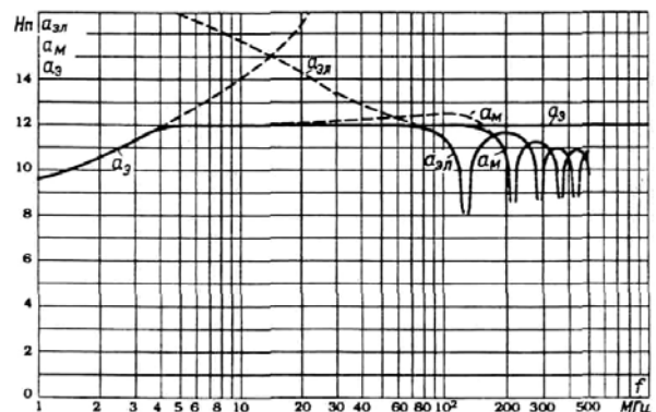
Рис. 10. Коэффициенты затухания измерительной кабины с длиной ребра 2 м и толщине экрана из медной фольги 0,1 мм
