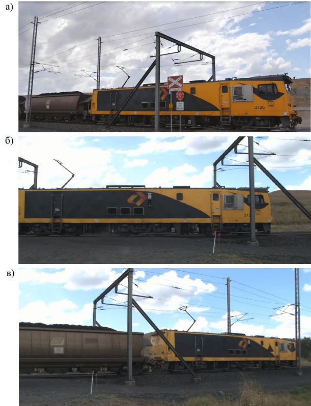
Рис. 11. Прохід електровозом зони струморозділення над переїздом: а) момент опускання струмоприймача; б) прохід переїзду; в) момент піднімання струмоприймача
