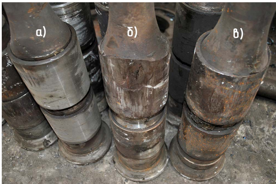
Рис. 4. Пошкодження стержнів і втулок коліскового підвішування кузова електровозів серій ВЛ11М, ВЛ80: а) стержень із новими втулками; б) стержень із надмірнозношеною втулкою та зношенням тіла стержня; в) зношення втулок стержня
